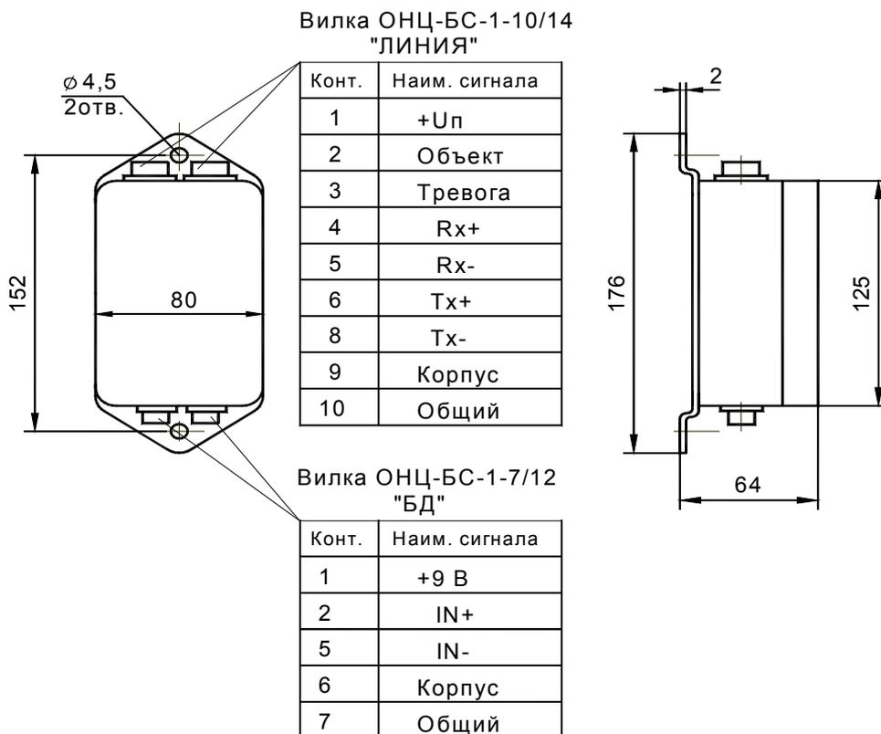
Предназначен для работы с блоками детектирования
