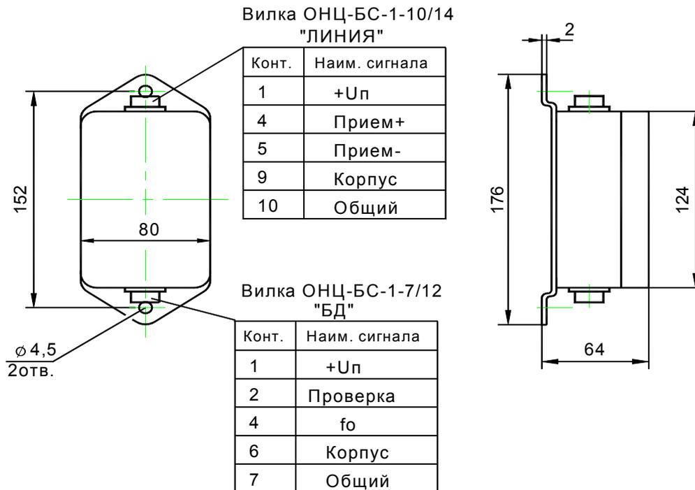
Предназначен для работы с блоком детектирования БДМН-100-07
