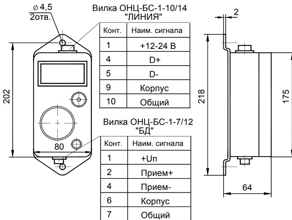
Предназначен для работы с блоком детектирования БДМГ-100-07
