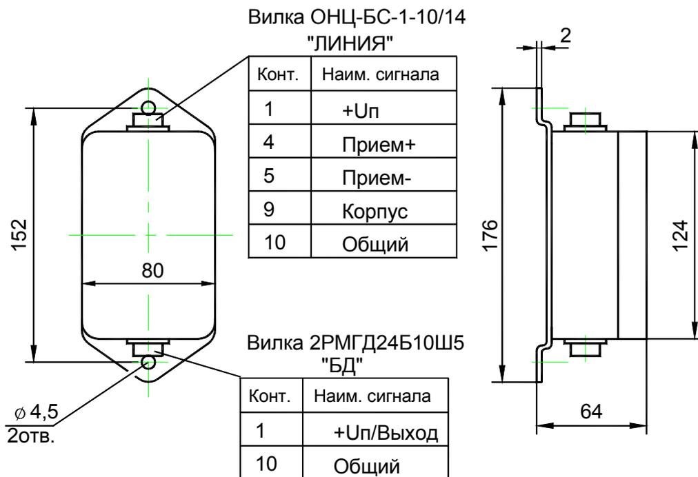
Предназначен для работы с блоком детектирования БДКГ-100-07
