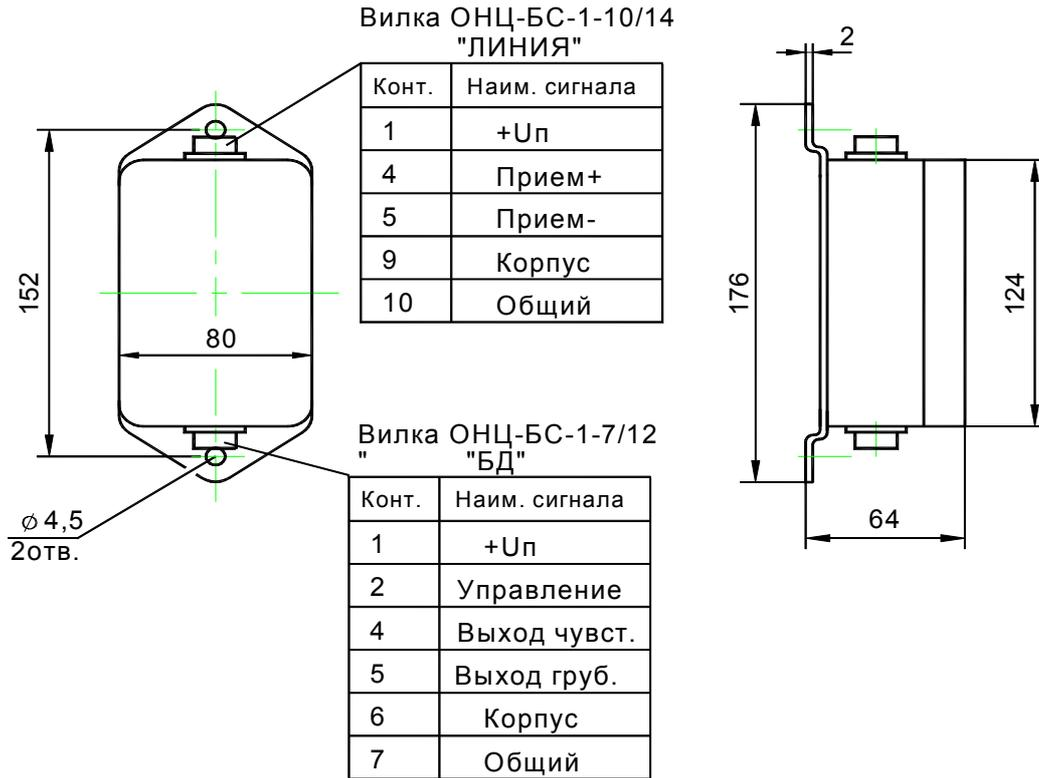
Предназначен для работы с блоком детектирования БДМГ-100-07
