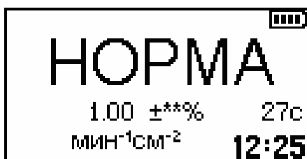
Рисунок 4. Режим «Пороговый». Измеренная величина не превышает заданную пороговую уставку
