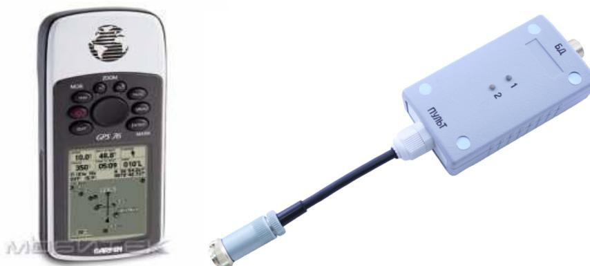
Рисунок 3 GPS навигатор Garmin GPS 76 (слева) и ГСП-01 (справа)
